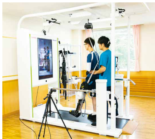
運動学習理論に基づき、機能回復に応じた適切な難易度の歩行練習が可能。リハビリ支援ロボット「ウェルウォークWW-1000」。麻痺側の脚にロボットを装着し、足の振り出しの補助、膝折れの防止などにより、患者さまの能力を最大限に引き出して歩く練習ができる
