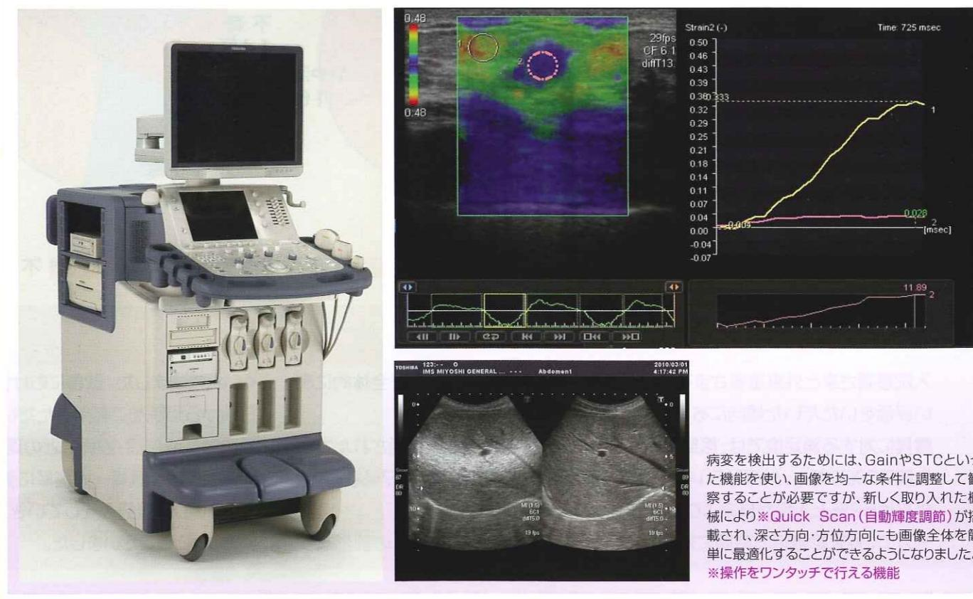
病変を検出するためには、GainやSTCといった機能を使い、画像を均一な条件に調整して観察することが必要ですが、新しく取り入れた機械により※Quick Scan(自動輝度調節)が搭載され、深さ方向・方位方向にも画像全体を簡単に最適化することができるようになりました。
